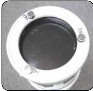
SPECCHIO PRIMARIO. LE VITI ZIGRINATE GRANDI SONO PER LA COLLIMAZIONE, MENTRE QUELLE PICCOLE SONO PER BLOCCARE LO SPECCHIO IN POSIZIONE.
