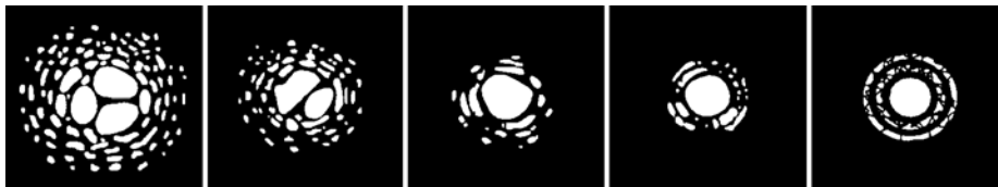
DIE SICHTBEDINGUNGEN WIRKEN SICH DIREKT AUF DIE BILDQUALITÄT AUS. DIESE ABBILDUNGEN STELLEN EINE PUNKTQUELLE (D.H. STERN) UNTER SCHLECHTEN SICHTBEDINGUNGEN (LINKS) BIS AUSGEZEICHNETEN SICHTBEDINGUNGEN (RECHTS) DAR. MEISTENS PRODUZIEREN SICHTBEDINGUNGEN BILDER, DIE IRGENDWO ZWISCHEN DIESEN EXTREMEN LIEGEN.
