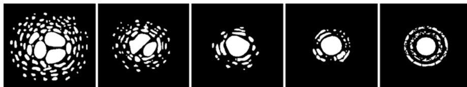
CONDITIONS DE VISIBILITÉ AFFECTANT DIRECTEMENT LA QUALITÉ DE L'IMAGE. CES DESSINS REPRÉSENTENT UNE SOURCE DE POINTS (AUTREMENT DIT UNE ÉTOILE) DANS DES CONDITIONS DE VISIBILITÉ VARIANT DE MÉDIOCRES (GAUCHE) À EXCELLENTE (DROITE). LE PLUS SOUVENT, LES CONDITIONS DE VISIBILITÉ PRODUISENT DES IMAGES SITUÉES ENTRE CES DEUX EXTRÊMES.
