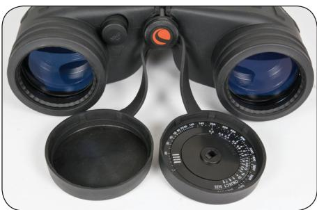
Per prima cosa misurare l'angolo di visione dell'oggetto e ruotare l'anello mobile e impostare il valore in corrispondenza del segno di indice dell'angolo. Quindi individuare la divisione che indica la misura dell'oggetto (vedere la formula sottostante), essa indica un punto sulla scala fissa. Guardare la scala fissa, la distanza è indicata a quel punto della scala fissa.
