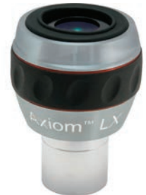
MX: 500102 USA: 93396 Ocular Axiom LX Distancia focal: 15 mm Descanso ocular: 13 mm Campo de visión: 82° Salida ocular: 1.25" Peso: 340 g
