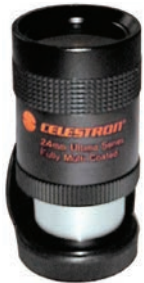
MX: 500096 USA: 93350 Ocular Ultima Distancia focal: 12,5 mm Descanso ocular: 9 mm Campo de visión: 51° Salida ocular: 1.25"
